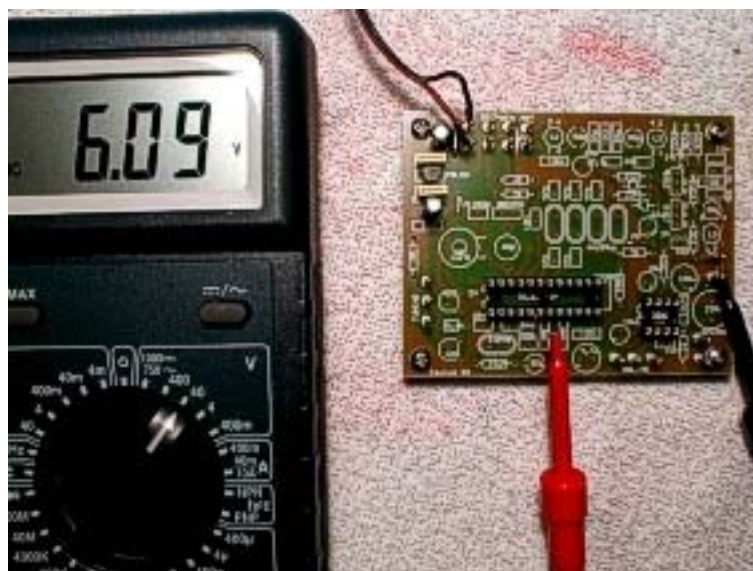
Sprawdzenie napięcia stabilizowanego 6V
