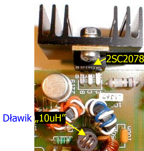
Stopień wzmacniacza mocy PA (Power Amplifier)
